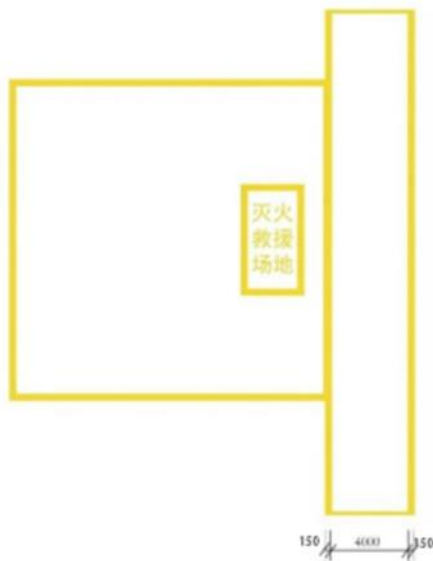
图4 灭火救援场地标线示意图（单位：mm）
