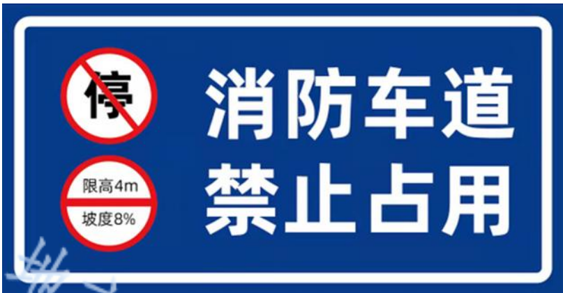
图9 消防车车道标牌示意图
