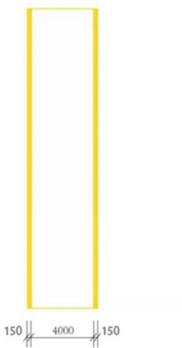
图1 消防车道直线标线（单位：mm）
